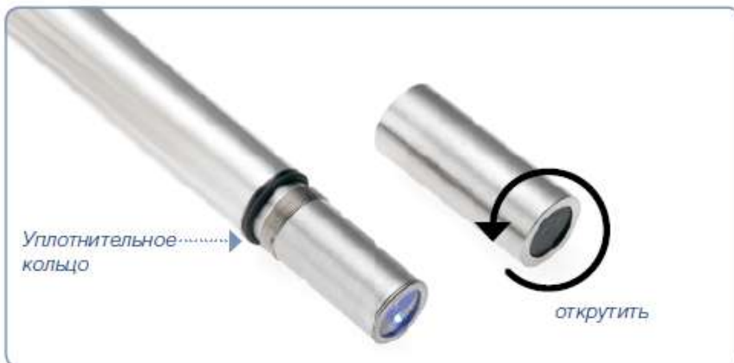
Рисунок 26 - Замена оптического колпачка
